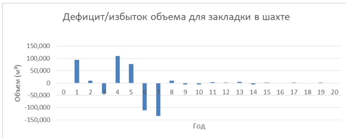
Рисунок 9.7.1: Баланс объема закладочного материала и объема доступного для закладки выработанного пространства
