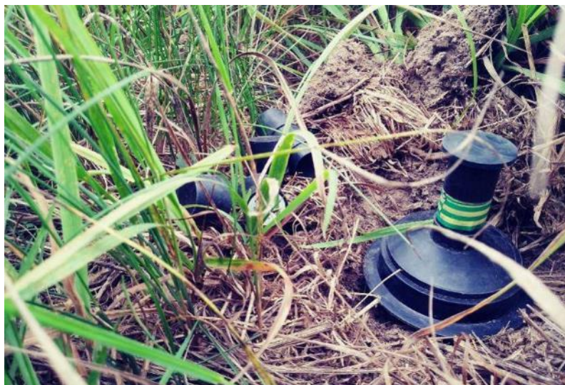
Рисунок 7.2.1 – Измерение плотности потока радона с поверхности почвы
